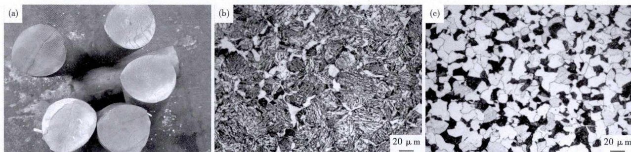
图5 20CrMnTiH 钢轧材(a)应力裂纹宏观形貌;(b)裂纹处上贝氏体组织形貌;(c)正常铁素体+珠光体组织形貌
